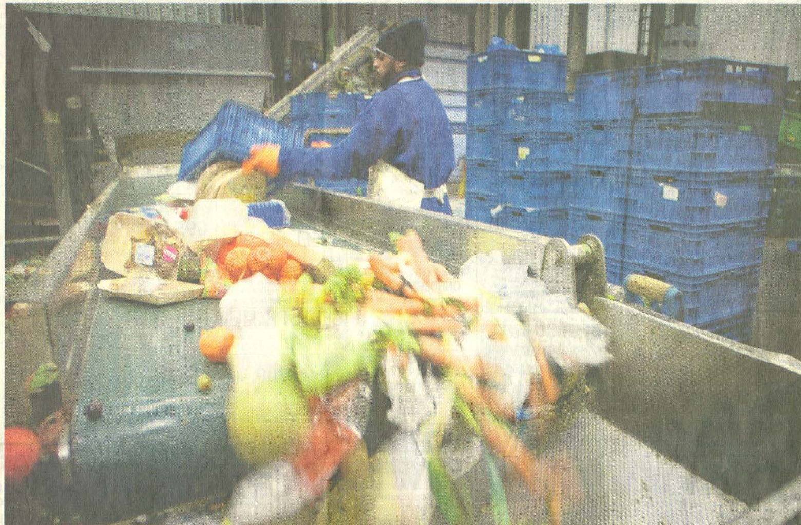
Afval van levensmiddelen uit supermarkten wordt bij Sita Food Recycling verwerkt tot grondstof voor het maken van groene stroom.
